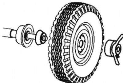
Рисунок 6.1 – Установка колеса
