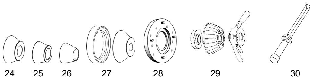
Рисунок 3.2 – Комплект №1 для установки легковых колес (по заказу)
