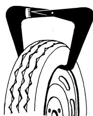
Рисунок 5.6 – Измерение ширины колеса кронциркулем
