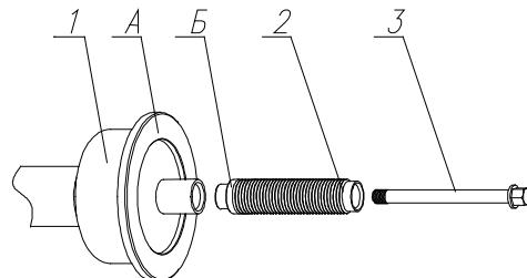
Рисунок 4.3 - Сборка вала
