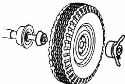
Рисунок 6.5 – Установка колеса
